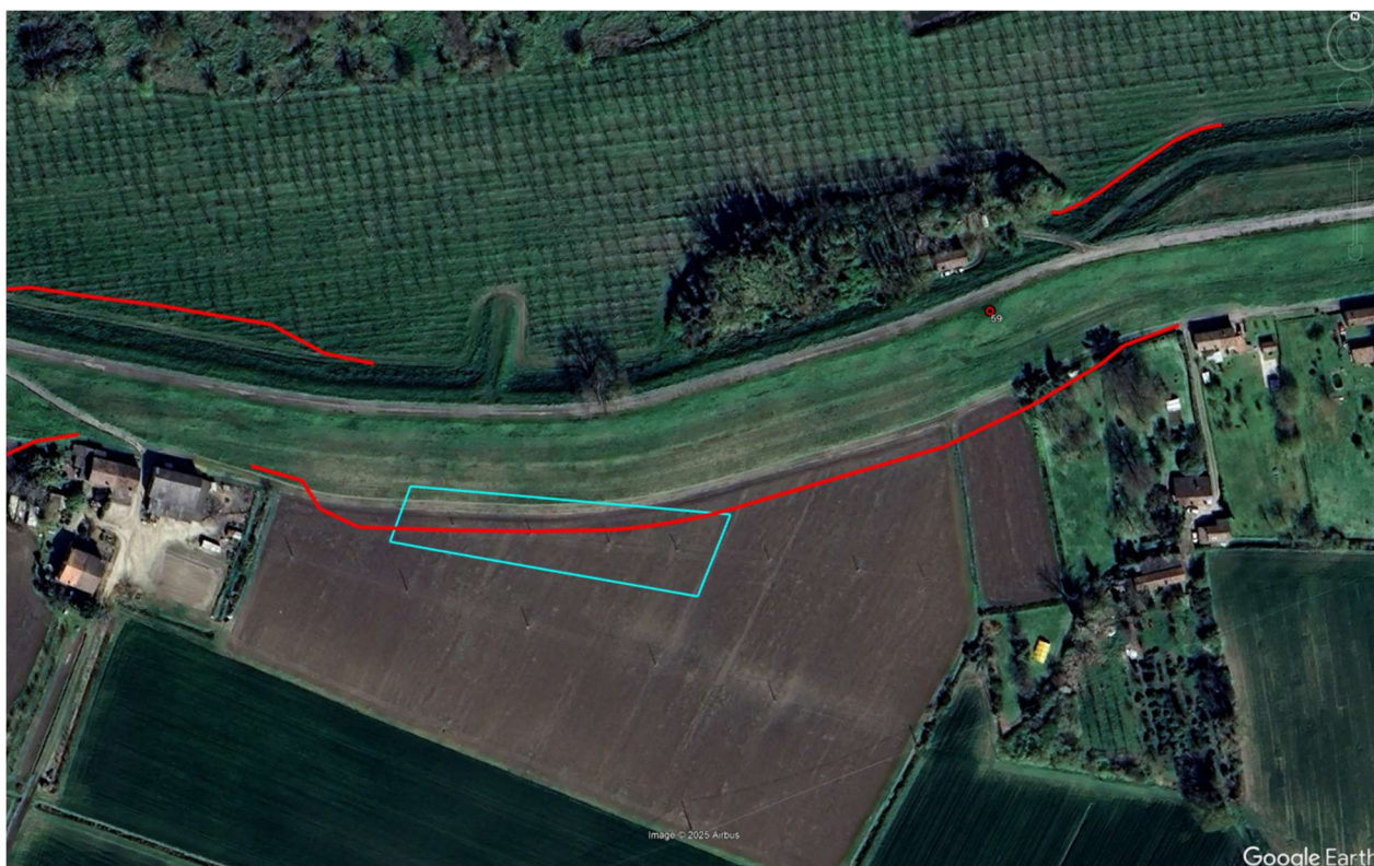
Fig. 2: interferenza tra la linea TIM (azzurro) e il nuovo sedime arginale in progetto (rosso)
